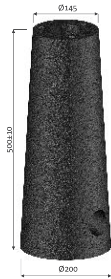
Бетонный фундамент B-0A
