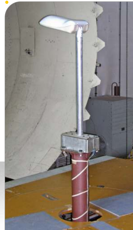
исследование светильника МАГНОЛИЯ в аэродинамическом туннеле
