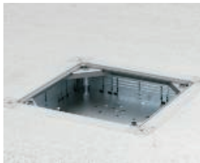
Подготовка системы прокладки кабеля под полом Четыре усиленных опоры крышки установить по углам монтажного основания и отрегулировать на необходимую высоту. Опорный винт зафиксировать контргайкой.
