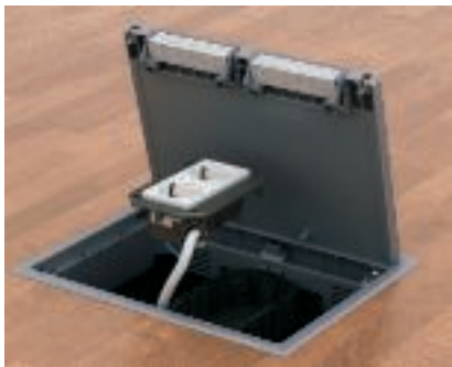
Монтаж электроустановочных изделий в коробке GB Электроустановочные изделия фиксируются в накладках и монтажных коробках без применения винтов. Устройства серии Modul 45® перед подключением необходимо установить в накладку.
