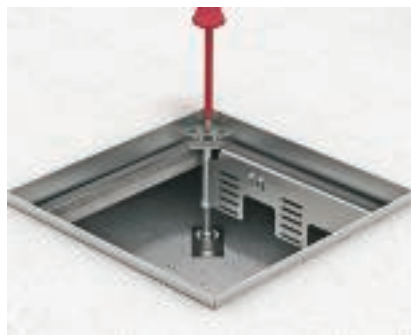
Регулирование высоты кассетной рамки Установить кассетную рамку на верхнюю кромку напольного покрытия. Отрегулированную высоту нивелировочных винтов зафиксировать с помощью контргаек.
