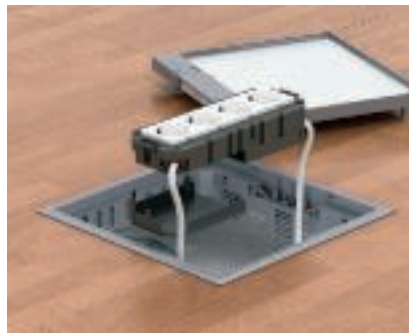
Монтаж электроустановочных изделий в модульной рамке MT Электроустановочные изделия размещаются в модульных рамках MT3/45 и MT4/45 перед монтажом в лючок. После подключения модульную рамку необходимо сверху установить в лючок.
