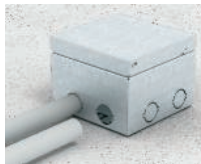
Подсоединение электромонтажных труб Подвести трубы M25, максимально допустимое погружение при этом составляет 5 мм.
