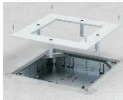
Подготовка системы прокладки кабеля под полом Усиленную крышку установить на монтажном основании. Отрегулировать опоры по высоте и закрепить контргайками.
