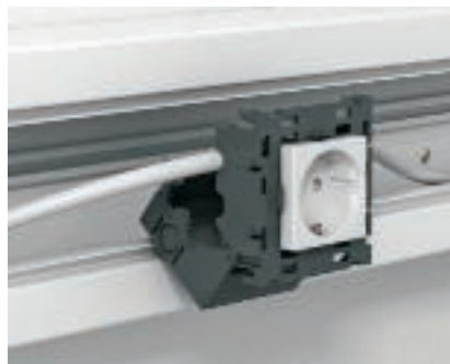
Соединение кабеля После установки в монтажную коробку можно соединять кабель. С обеих сторон расположены выемки, через которые можно фиксировать любые стандартные виды кабеля.
