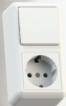
БКВР-405 Блок комбинированный Выключатель одноклавишный + розетка с заземляющим контактом Ном. ток выключателя - 10А Ном. ток розетки - 16А 62x116x44,6 мм
