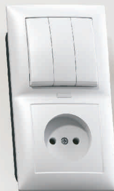
БКВР-419 Блок комбинированный Выключатель трехклавишный с подсветкой + розетка Номинальный ток: - выключателя - 10А - розетки - 16А 80,4x150,4x43,3 мм
