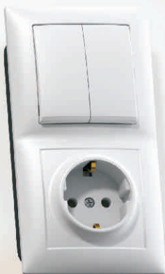
БКВР-412 Блок комбинированный Выключатель двухклавишный + розетка с заземляющим контактом Номинальный ток: - выключателя - 10А - розетки - 16А 80,4x150,4x45,4 мм
