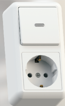
БКВР-432 Блок комбинированный Выключатель одноклавишный с подсветкой + розетка с заземляющим контактом Ном. ток выключателя - 10А Ном. ток розетки - 16А 62x116x44,6 мм
