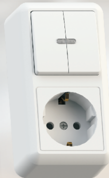
БКВР-433 Блок комбинированный Выключатель двухклавишный с подсветкой + розетка с заземляющим контактом Ном. ток выключателя - 10А Ном. ток розетки - 16А 62x116x44,6 мм
