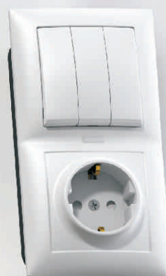
БКВР-425 Блок комбинированный Выключатель трехклавишный с подсветкой + розетка с заземляющим контактом и защитной шторкой Номинальный ток: - выключателя - 10А - розетки - 16А 80,4x150,4x45,7 мм
