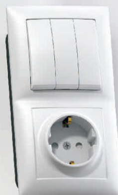
БКВР-416 Блок комбинированный Выключатель трехклавишный + розетка с заземляющим контактом и защитной шторкой Номинальный ток: - выключателя - 10А - розетки - 16А 80,4x150,4x45,7 мм
