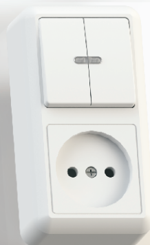
БКВР-431 Блок комбинированный Выключатель двухклавишный с подсветкой + розетка Ном. ток выключателя - 10А Ном. ток розетки - 16А 62x116x35,9 мм
