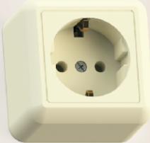
PA16-376 с/к Розетка одноместная с заземляющим контактом Номинальный ток - 16А 62x62x41,3 мм
