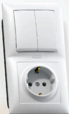
БКВР-421 Блок комбинированный Выключатель двухклавишный с подсветкой + розетка с заземляющим контактом Номинальный ток: - выключателя - 10А - розетки - 16А 80,4x150,4x45,4 мм
