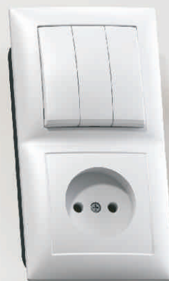
БКВР-410 Блок комбинированный Выключатель трехклавишный + розетка Номинальный ток: - выключателя - 10А - розетки - 16А 80,4x150,4x43,3 мм
