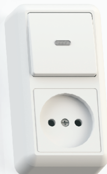
БКВР-430 Блок комбинированный Выключатель одноклавишный с подсветкой + розетка Ном. ток выключателя - 10А Ном. ток розетки - 16А 62x116x35,9 мм
