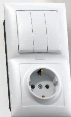
БКВР-422 Блок комбинированный Выключатель трехклавишный с подсветкой + розетка с заземляющим контактом Номинальный ток: - выключателя - 10А - розетки - 16А 80,4x150,4x45,4 мм
