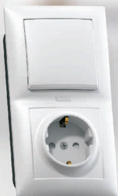
БКВР-423 Блок комбинированный Выключатель одноклавишный с подсветкой + розетка с заземляющим контактом и защитной шторкой Номинальный ток: - выключателя - 10А - розетки - 16А 80,4x150,4x45,7 мм
