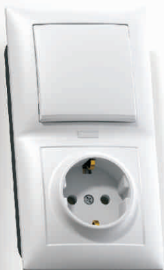
БКВР-420 Блок комбинированный Выключатель одноклавишный с подсветкой + розетка с заземляющим контактом Номинальный ток: - выключателя - 10А - розетки - 16А 80,4x150,4x45,4 мм
