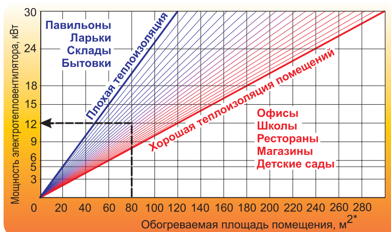
График 2. Определение необходимой мощности тепловентилятора серии T
