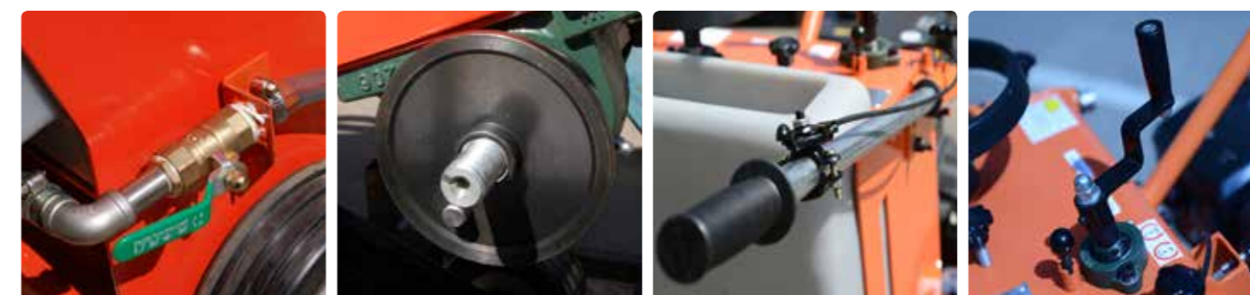
Кран системы орошения Крепление алмазного диска Рукоятка дросселя на ручке управления Рукоятка регулировки глубины реза
