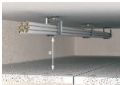
Необходимое минимальное расстояние до огнестойкого потолка
