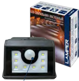
602-210 LED светильник настенный на солнечной батарее Заряжается в дневное время 2 режима работы Количество диодов: 8 шт. Угол рассеивания: 110 градусов, 3-5 м Степень влагозащиты IP44
