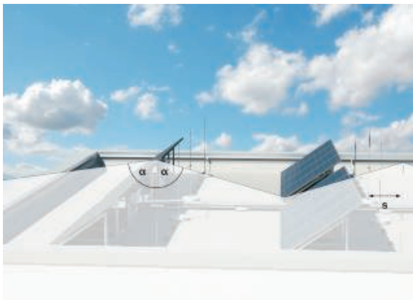
\alpha^\circ = защитный угол, s = разделительный интервал
