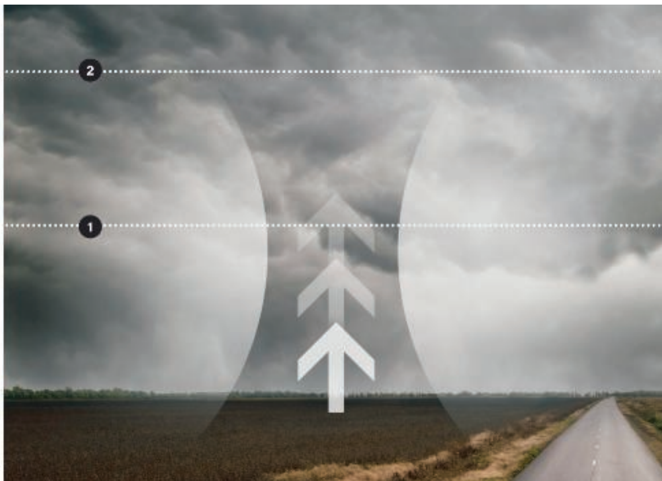
Возникновение грозовых разрядов: 1 = около 6 000 м, приблизительно -30^{\circ}\text{C} , 2 = около 15 000 м, приблизительно -70^{\circ}\text{C}
