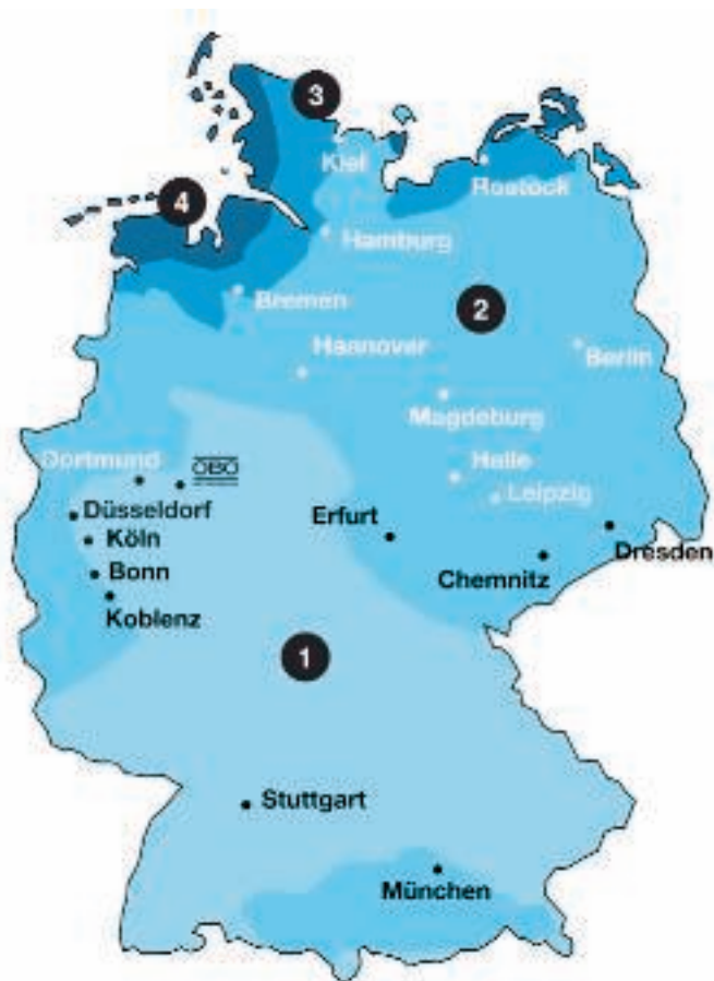
Зоны ветровой нагрузки в Германии в соответствии с DIN 1055-4
