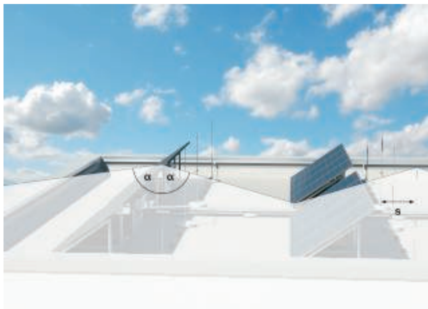
\alpha^\circ = защитный угол, s = разделительный интервал
