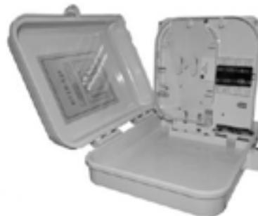
Кросс-муфта GJS-X20A имеет два кабельных ввода и шестнадцать выводов под патчкорды. Сплайс-пластина предусматривает возможность установки в гильзе оптического разветвителя 1\*2 или WDM сплиттера. Герметичность кросс-муфты GJS-X20 обеспечивается уплотнительной прокладкой, расположенной по периметру крышки и винтовым механизмом, прочно стягивающим крышку и корпус муфты. Это позволяет использовать ее для наружной и внутренней инсталляции.
