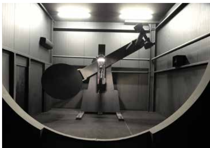
Новейшее оборудование для выполнения фотометрических исследований в лаборатории POCA.
