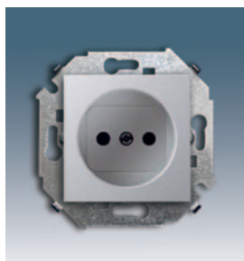
1591431 -030 -031 -032 -033 -034 -036 Розетка без заземления 2P, 250 В, 16 А
