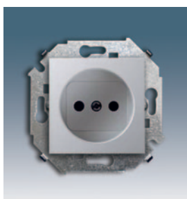
1591444 -030 -031 -032 -033 -034 -036 Розетка без заземления 2P, с защитными шторками, 250 В, 16 А
