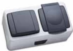
Выключатель одноклавишный + Розетка с крышкой и заземлением 37064202 10 AX, 250 V~ / 16 A, 250 V~ EN 60669-1 / IEC 60884-1 К-во шт/пакет / К-во шт/коробка - 6 / 60
