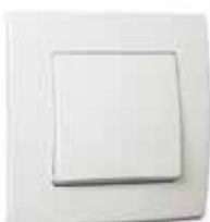
Выключатель одноклавишный * проходной 32001005 10 AX, 250 V~ EN 60669-1 К-во шт/пакет / К-во шт/коробка - 12 / 120
