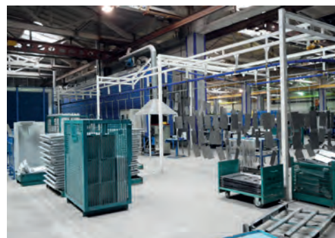
Участок порошковой покраски
