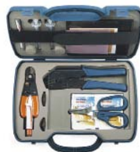
Для оконцовки оптического кабеля
