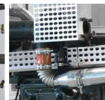
Защитные решетки на горячих деталях двигателя
