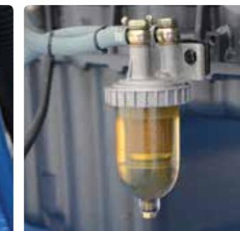
Топливный фильтр - влагоотделитель
