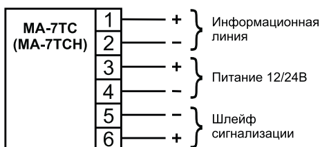
Рис.71 Назначение клемм адресных меток МА-7ТС.
