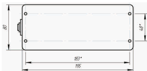
Рис.59 Габаритные и установочные размеры табло. Слева показан кабельный ввод.
