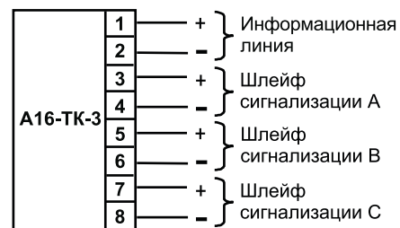
Рис.29 Назначение клемм адресных меток А16-ТК-3.
